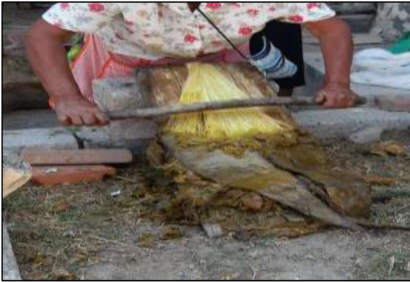
Foto 12. Extracción de fibra de la penca de maguey. Foto. Cazares, Evelyn, 2019.
